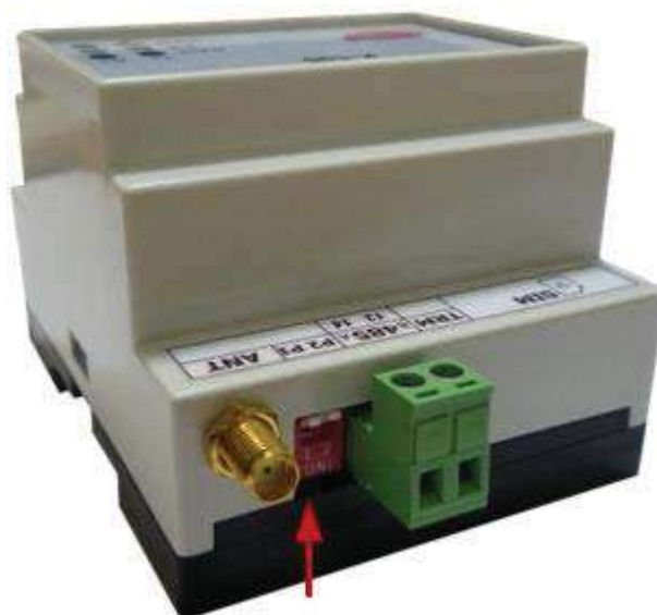
Рисунок 49. Установка движкового переключателя 1 в положение OFF
