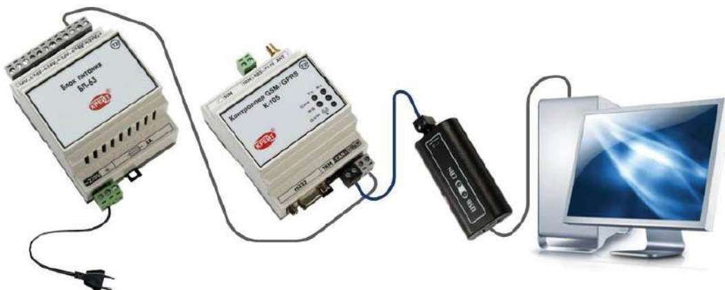
Рисунок 7. Подключение контроллера к компьютеру по интерфейсу CAN-BUS
