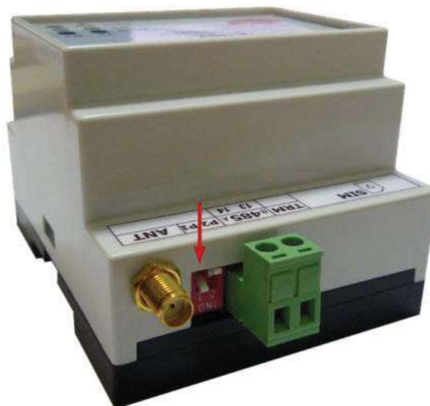
Рисунок 9. Установка движкового переключателя 1 в положение ON
