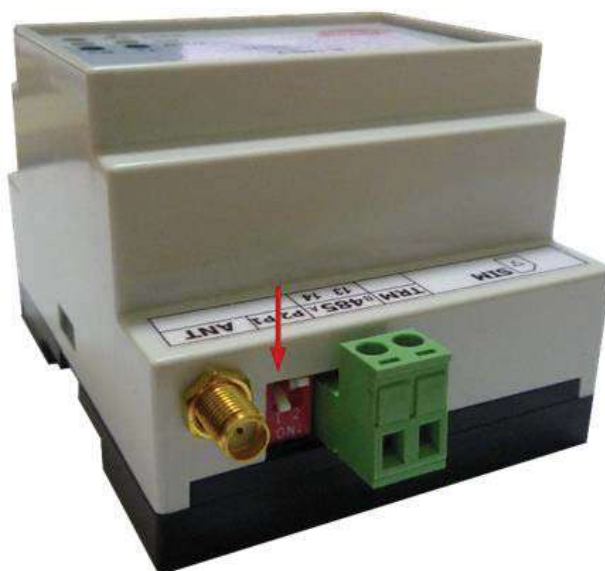
Рисунок 52. Установка движкового переключателя 1 в положение ON
